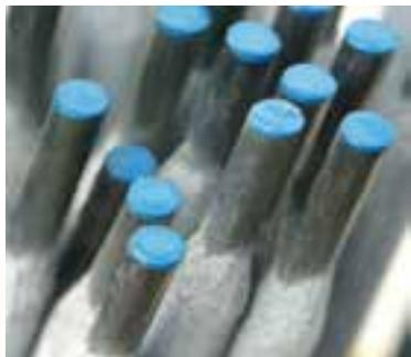
جنس روکش این الکترودها از تیتانیم سفید و مقداری سلولز است. از این الکترودها در جوشکاری پاس ریشه استفاده می‌شود. حجم سرباره آن‌ها کم بوده و به راحتی از روی کار کنده می‌شود. به دلیل وجود هیدروژن در ترکیبات روکش، حرارت بالایی ایجاد شده و عمق نفوذ جوش افزایش می‌یابد.
