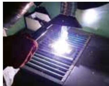
قوس الکتریکی زمانی ایجاد می‌شود که جریان برق در مدار الکتریکی آن که شامل مولدانژی، کابل‌های اتصال و انبر، الکترود، و قطعه کار است، برقرار گردد. در چین حالتی پس از تماس الکترود با قطعه کار، قوس الکتریکی ایجاد می‌شود (شکل ۴-۲).
